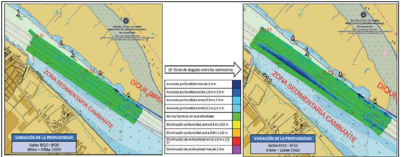
Figura 16. Diferencia de superficie entre el 07 y 12 de marzo del 2023.
