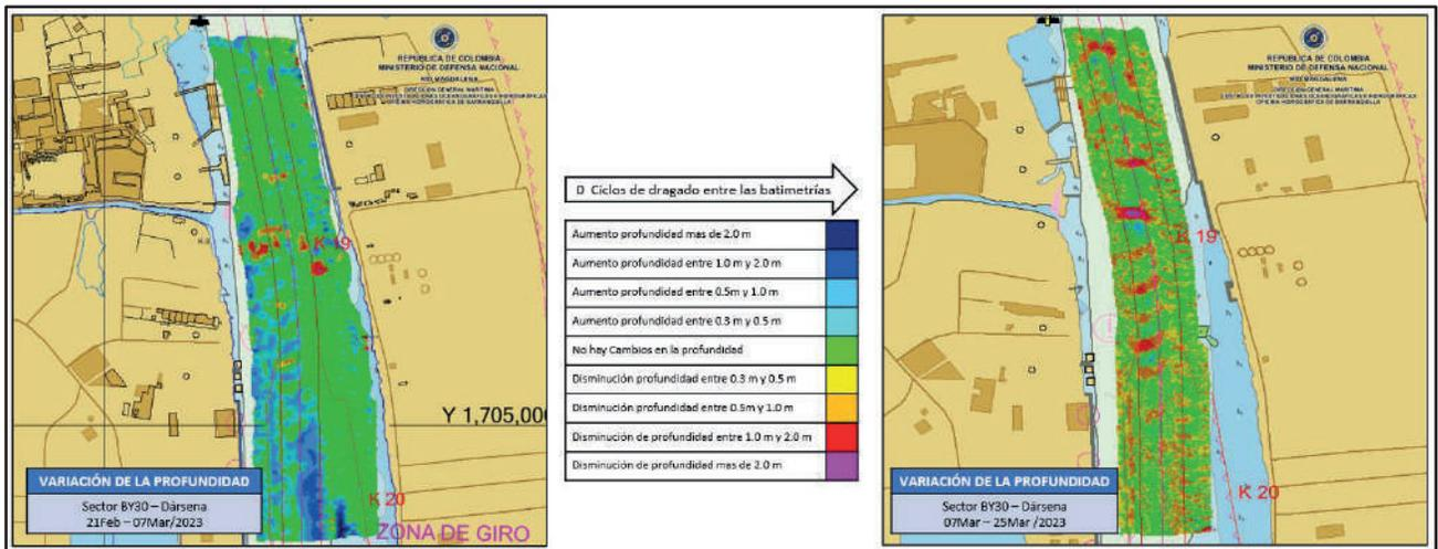
Figura 30. Diferencia de superficie entre el 07 y el 25 de marzo del 2023.
