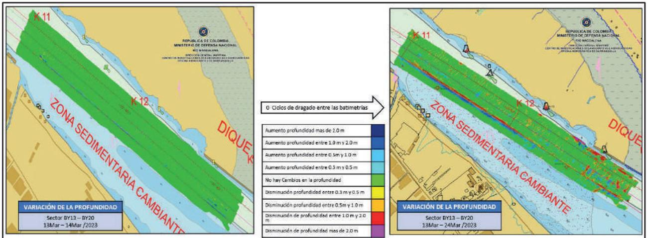
Figura 19. Diferencia de superficie entre el 13 y 24 de marzo del 2023
