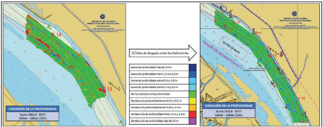
Figura 26. Diferencia de superficie entre el 16 y 26 de marzo del 2023
