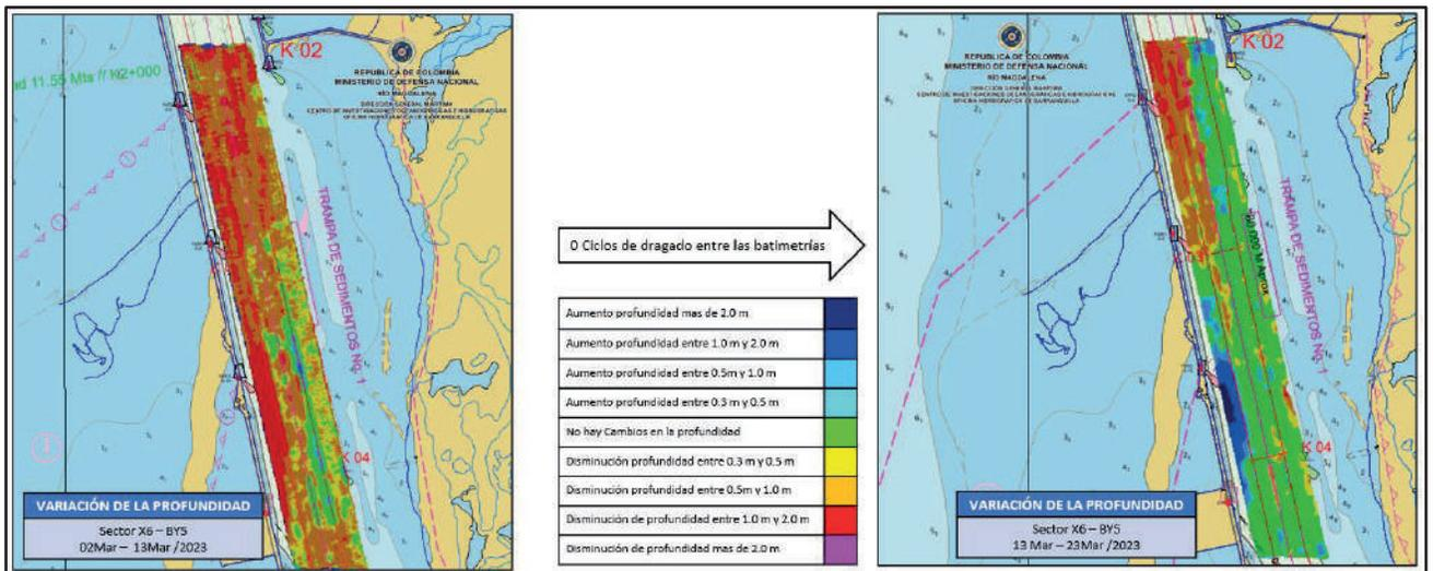
Figura 8. Diferencia de superficie entre el 13 y el 23 de marzo del 2023
