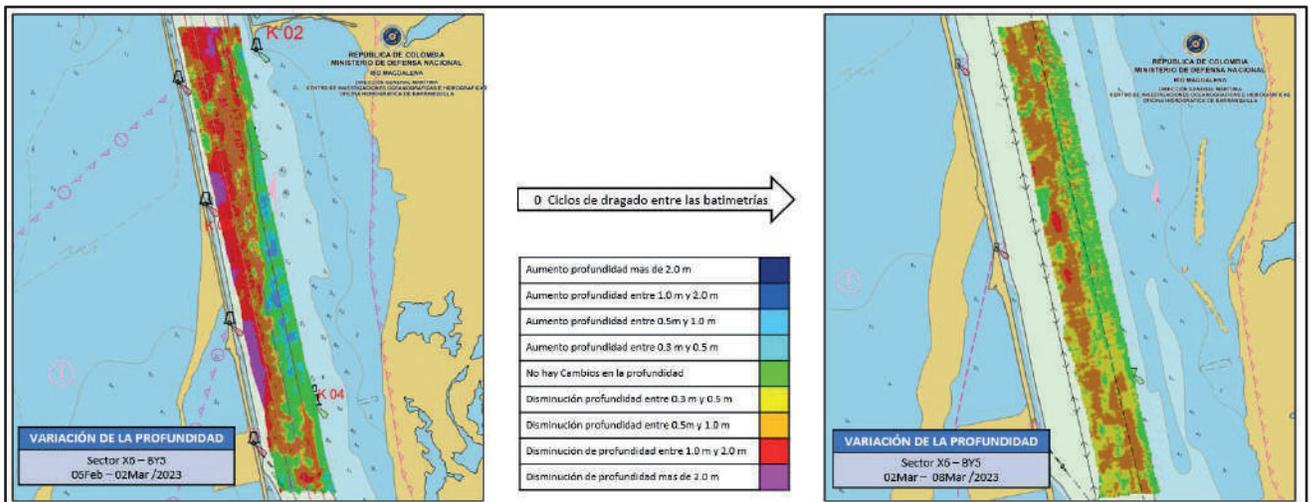
Figura 6. Diferencia de superficie entre el 02 y el 08 de marzo del 2023.
