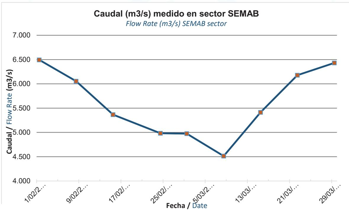
**Figura 33.** Evolución comportamiento caudal sección transversal km 8+500.
