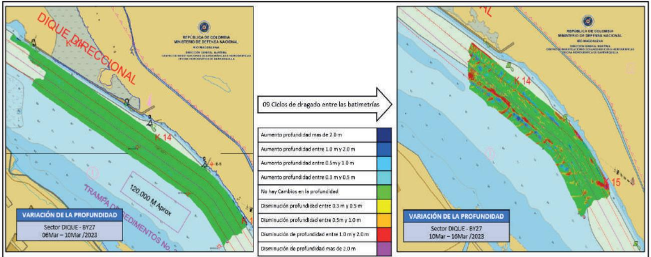
Figura 25. Diferencia de superficie entre el 10 y 16 de marzo del 2023.
