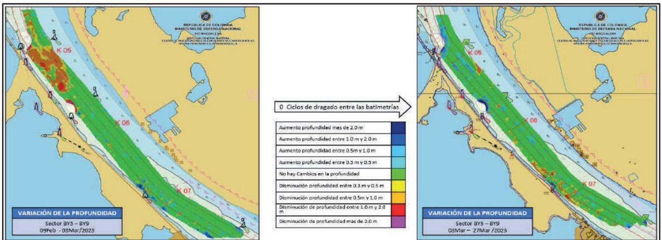
Figura 11. Diferencia de superficie entre el 03 y el 27 de marzo del 2023.
