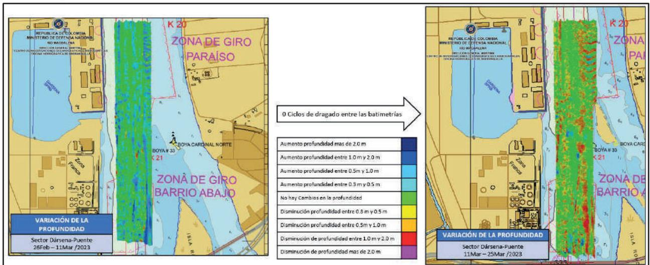
Figura 32. Diferencia de superficie entre el 11 y 25 de marzo del 2023.
