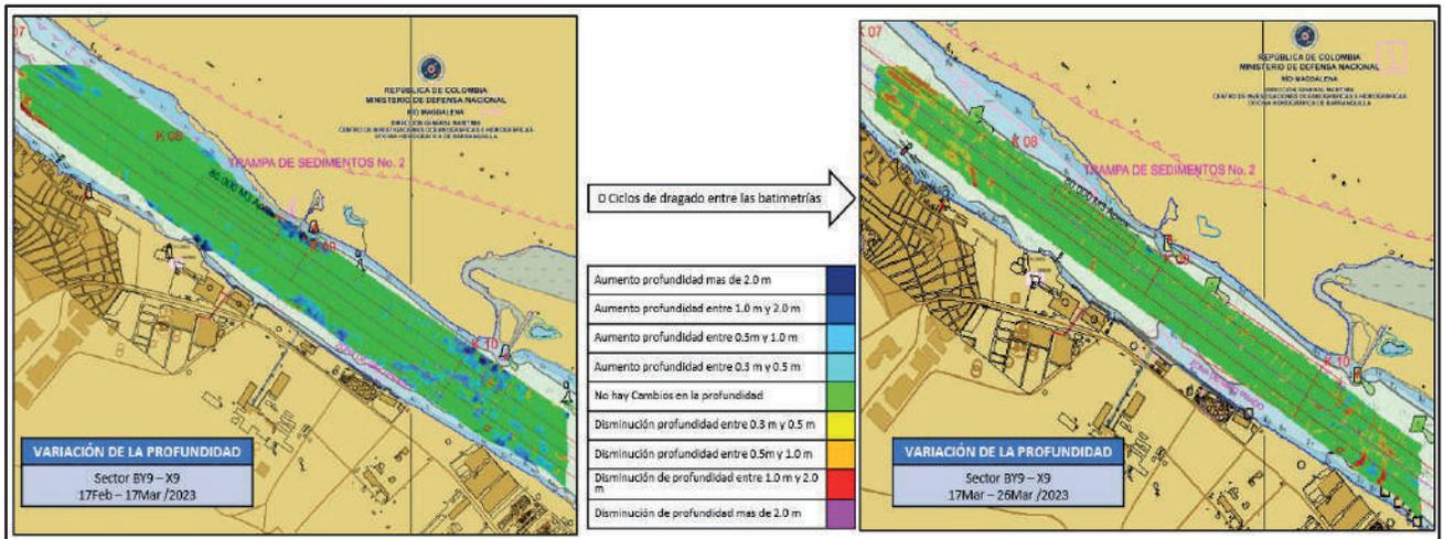
Figura 13. Diferencia de superficie entre el 17 y 26 de marzo del 2023.
