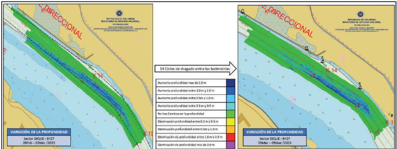
Figura 22. Diferencia de superficie entre el 03 y 05 de marzo del 2023.
