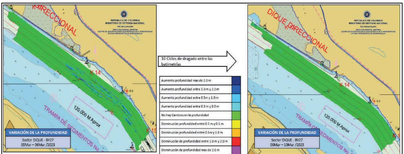
Figura 24. Diferencia de superficie entre el 06 y 10 de marzo del 2023.
