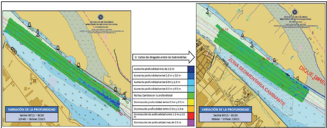
Figura 15. Diferencia de superficie entre el 06 y 07 de marzo del 2023.
