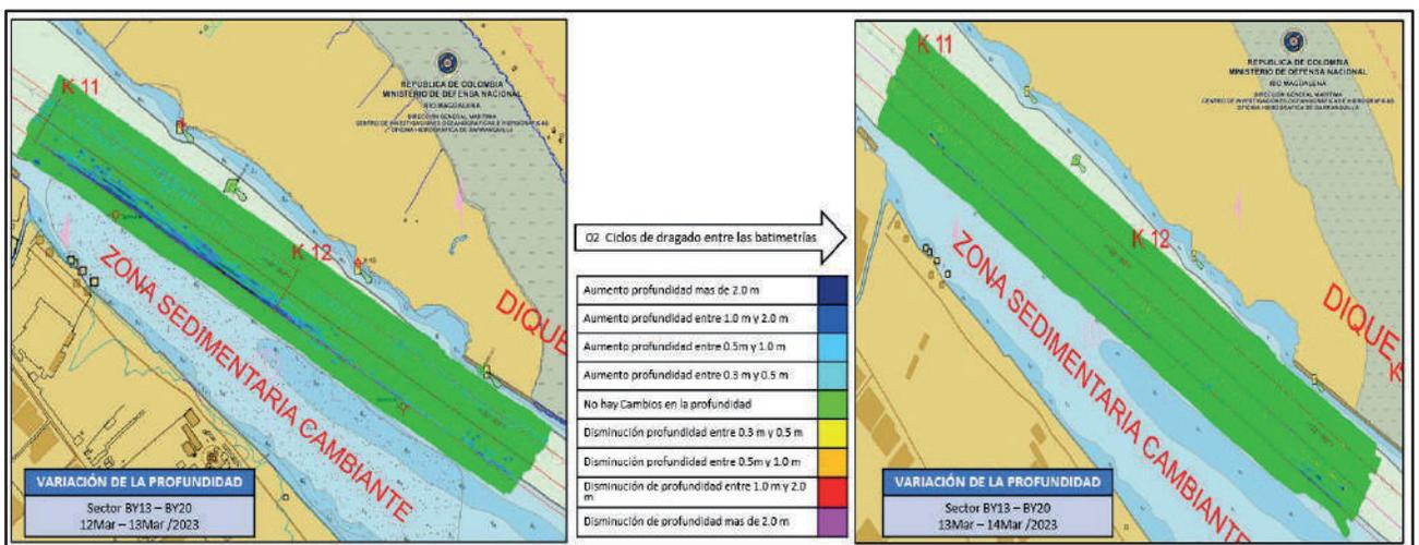
Figura 18. Diferencia de superficie entre el 13 y 14 de marzo del 2023
