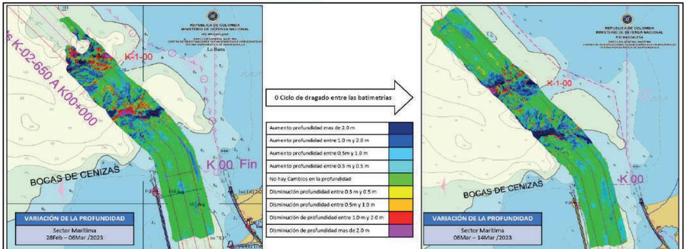
Figura 2. Diferencia de superficie entre el 06 y 14 de marzo del 2023.
