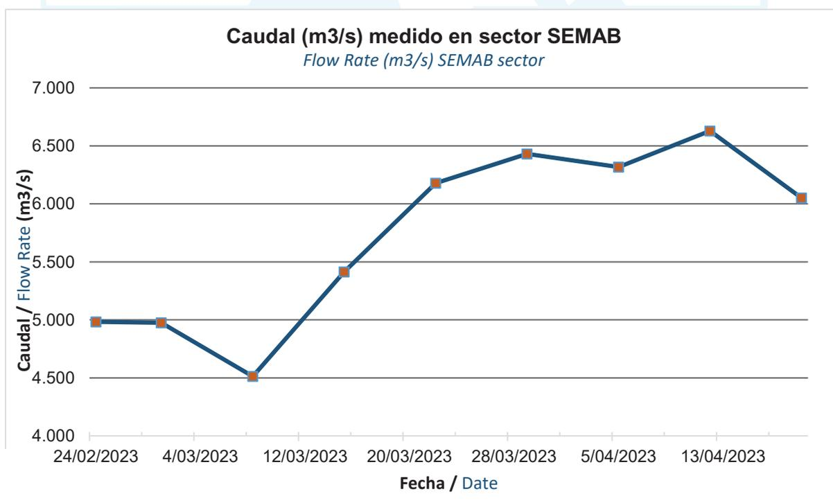
**Figura 28.** Evolución comportamiento caudal sección transversal km 8+500.
