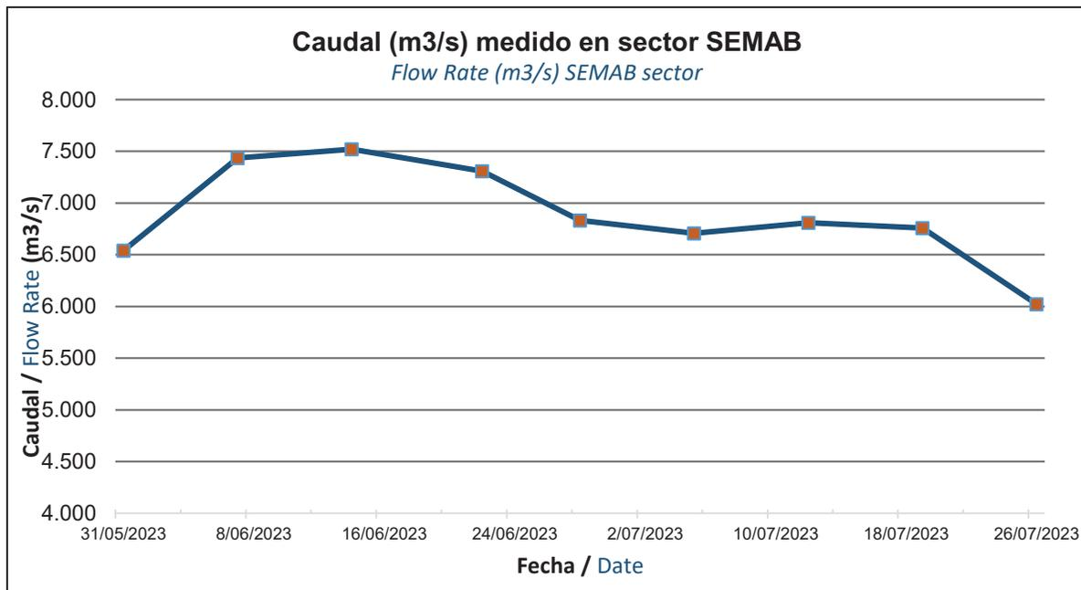
Figura 33. Evolución comportamiento caudal sección transversal km 8+500.
