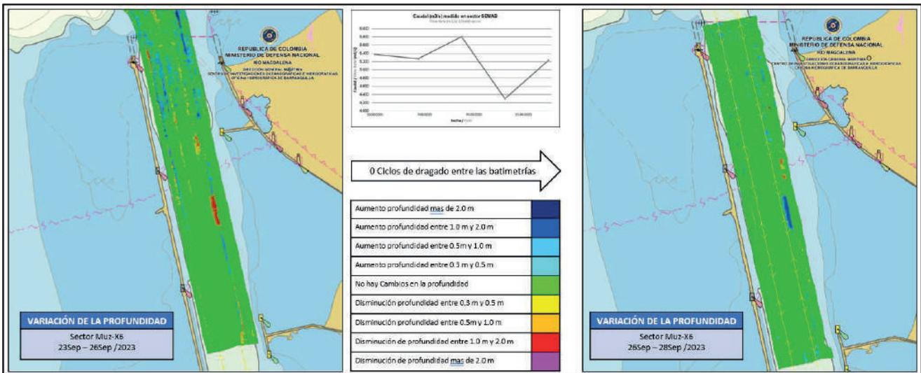
Figura 17. Diferencia de superficie entre el 26 y 28 de septiembre del 2023
