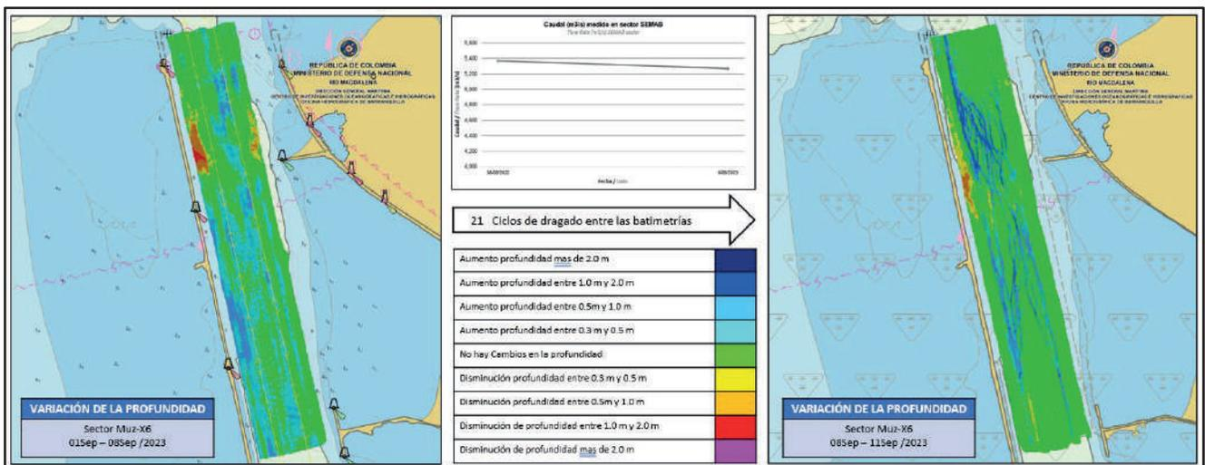
Figura 9. Diferencia de superficie entre el 08 y 11 de septiembre del 2023.
