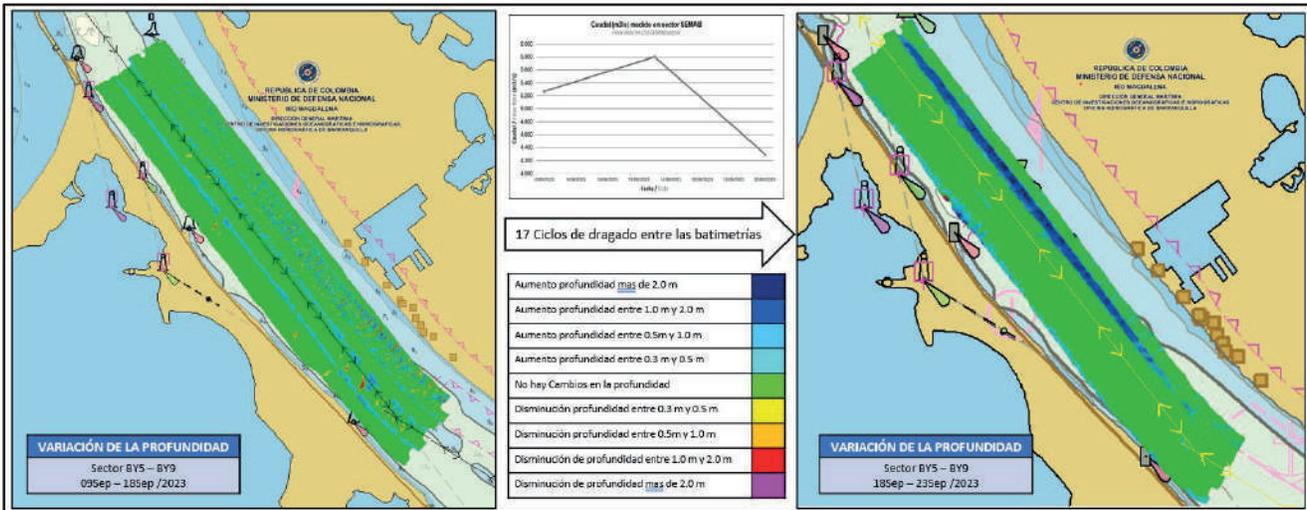
Figura 25. Diferencia de superficie entre el 18 y 23 de septiembre del 2023.
