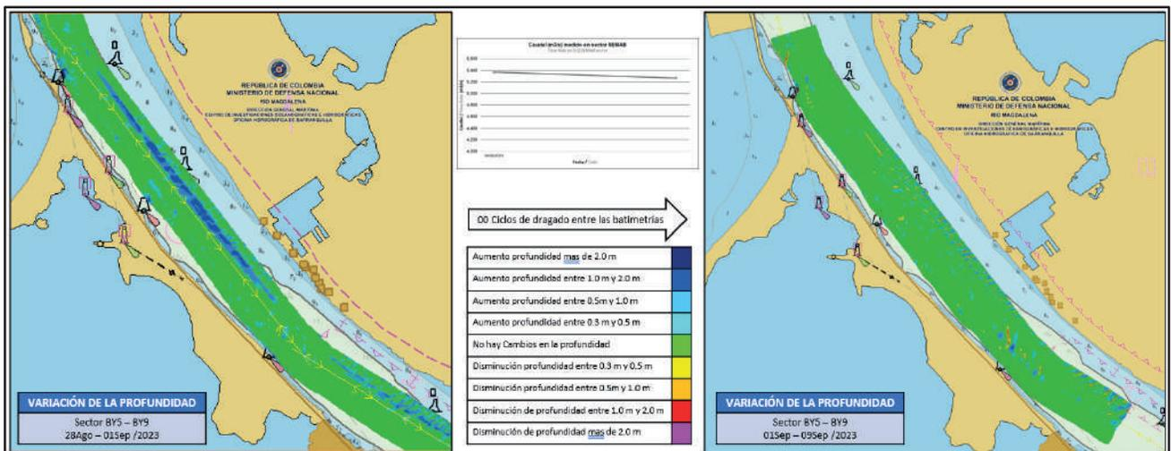
Figura 23. Diferencia de superficie entre el 01 y 09 de septiembre del 2023.
