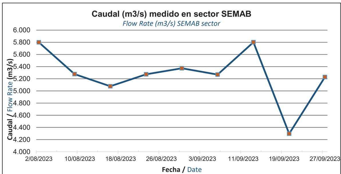
Figura 36. Evolución comportamiento caudal sección transversal km 8+500.
