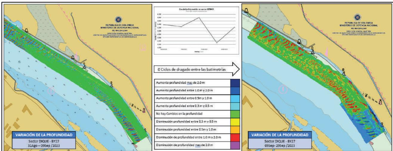
Figura 30. Diferencia de superficie entre el 09 y 29 de septiembre del 2023.
