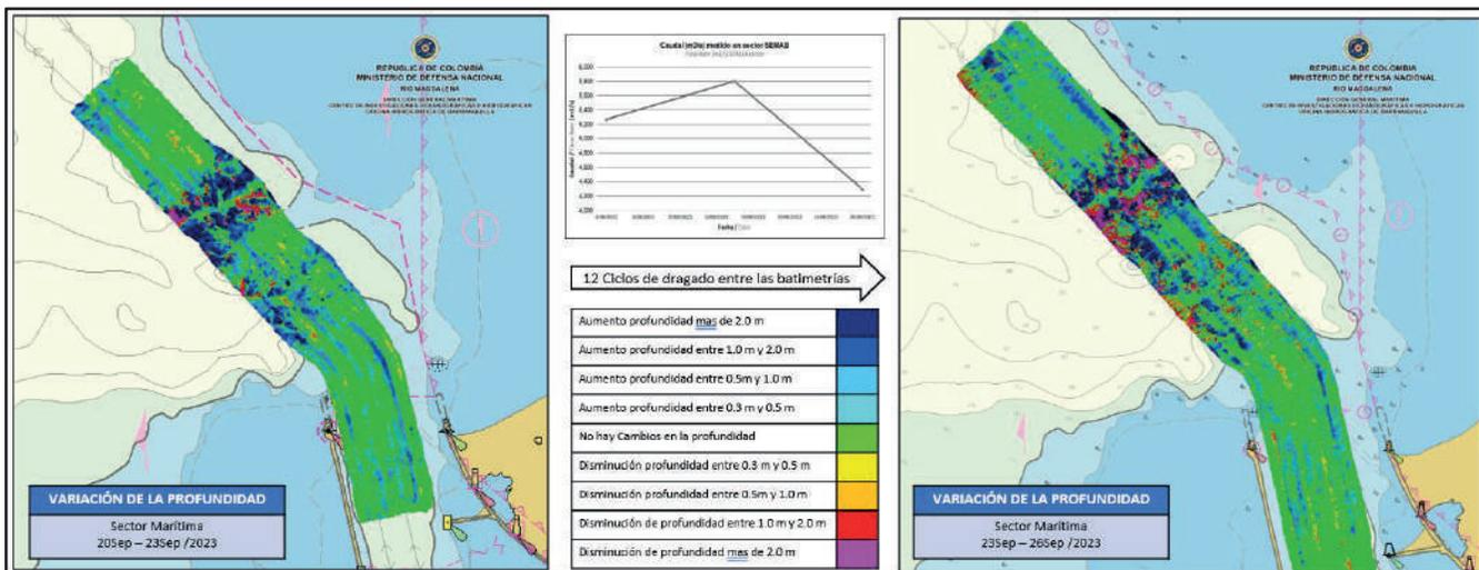
Figura 6. Diferencia de superficie entre el 23 y 26 de septiembre del 2023.
