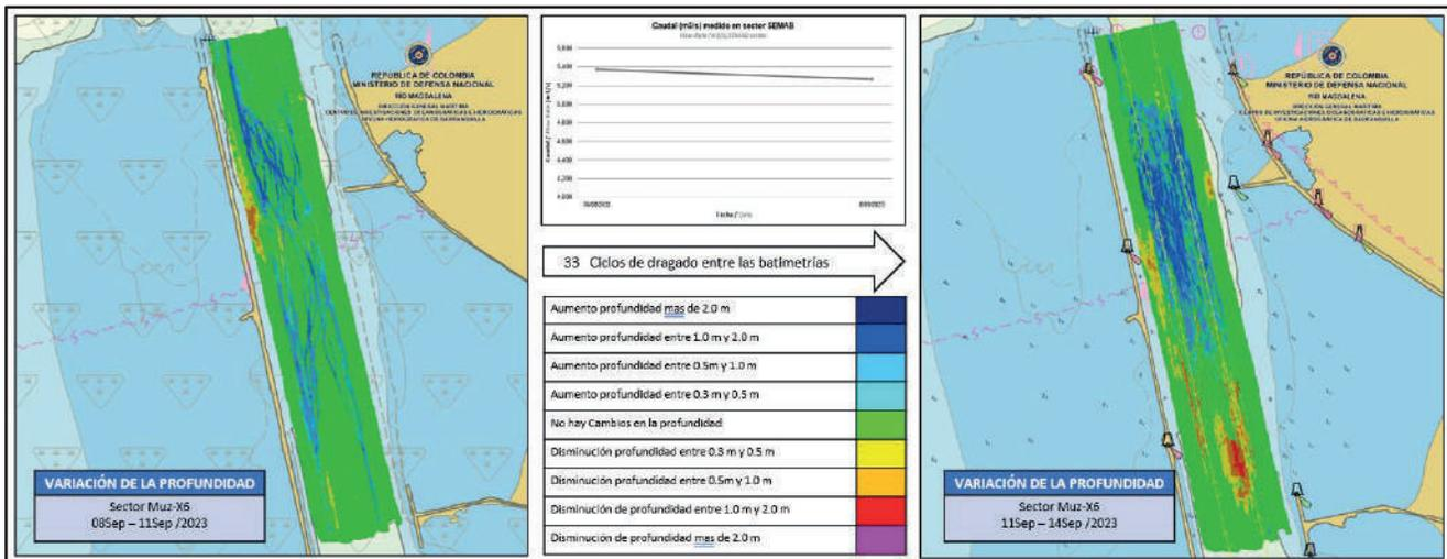
Figura 10. Diferencia de superficie entre el 11 y 14 de septiembre del 2023.
