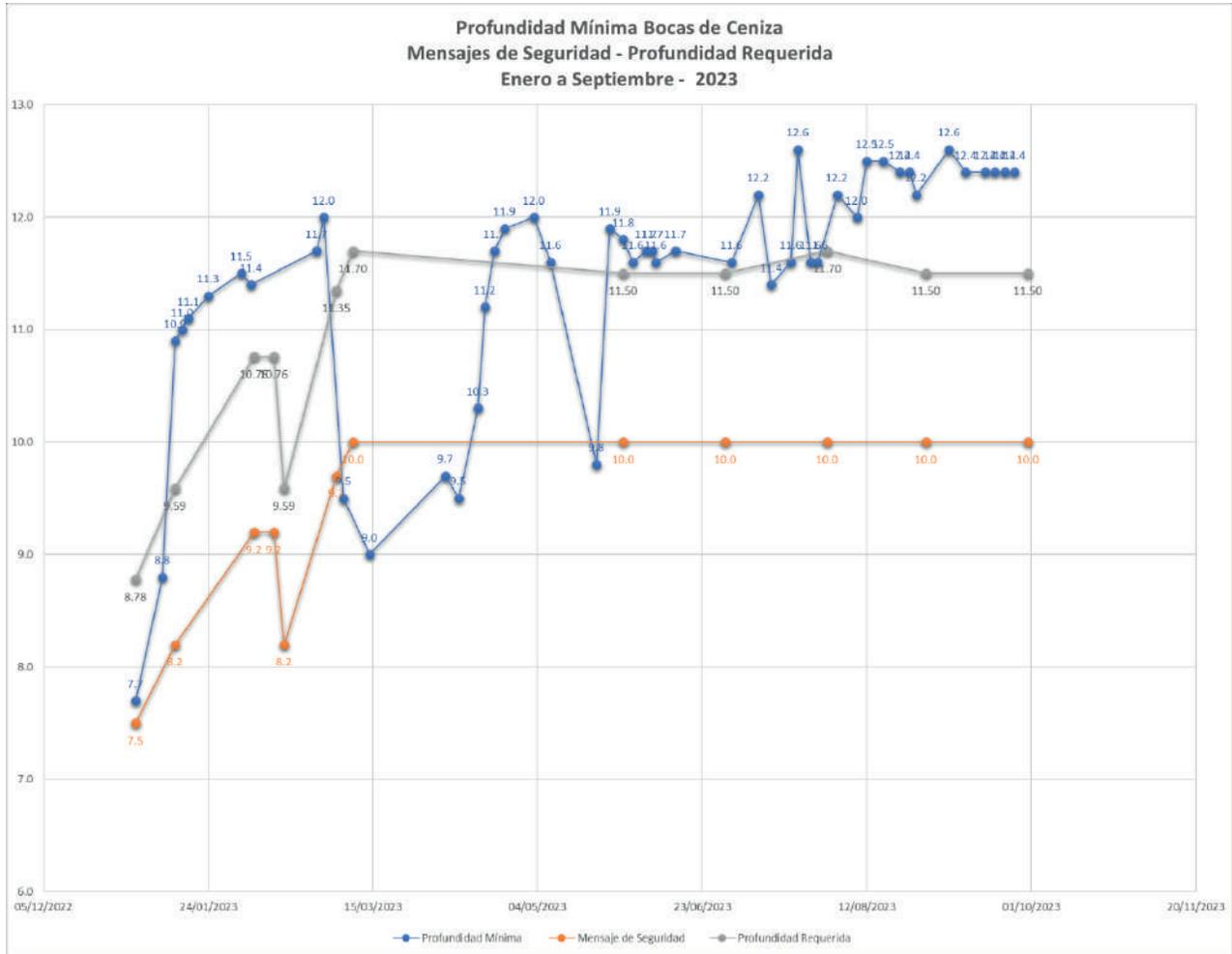
Figura 38. Correlación de profundidad mínima Vs los mensajes de seguridad durante el mes enero a septiembre del 2023.
