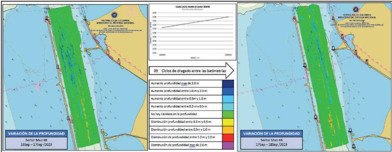
Figura 13. Diferencia de superficie entre el 17 y 18 de septiembre del 2023.
