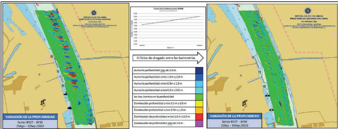
Figura 32. Diferencia de superficie entre el 12 y 16 de septiembre del 2023.
