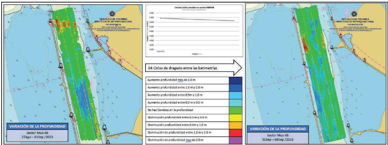
Figura 8. Diferencia de superficie entre el 01 y 08 de septiembre del 2023.
