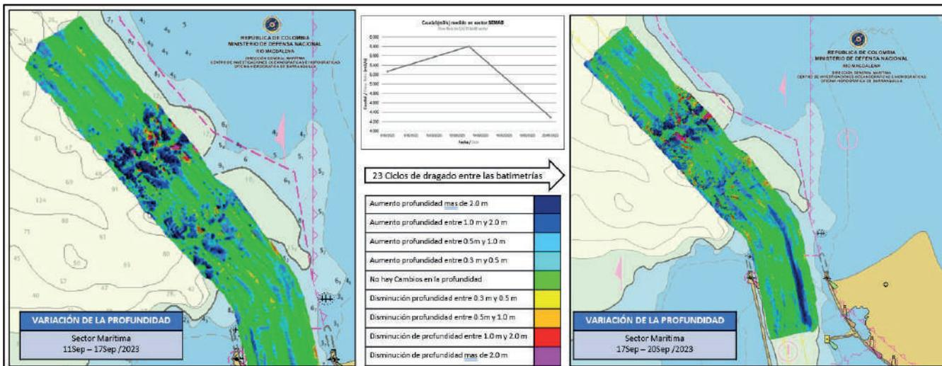
Figura 4. Diferencia de superficie entre el 17 y 20 de septiembre del 2023.
