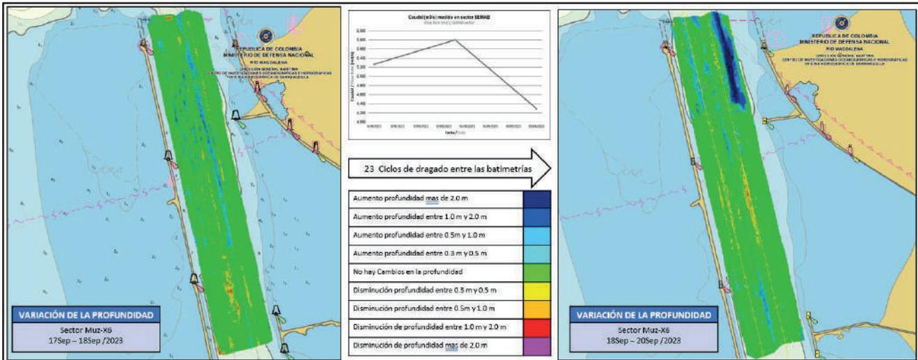
Figura 14. Diferencia de superficie entre el 18 y 20 de septiembre del 2023.
