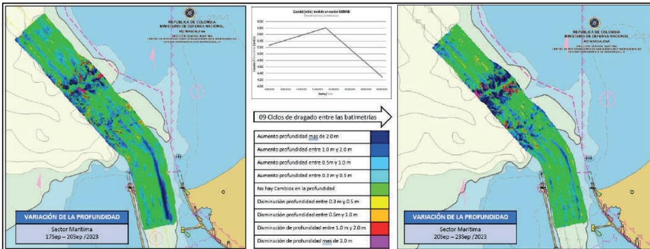
Figura 5. Diferencia de superficie entre el 20 y 23 de septiembre del 2023.
