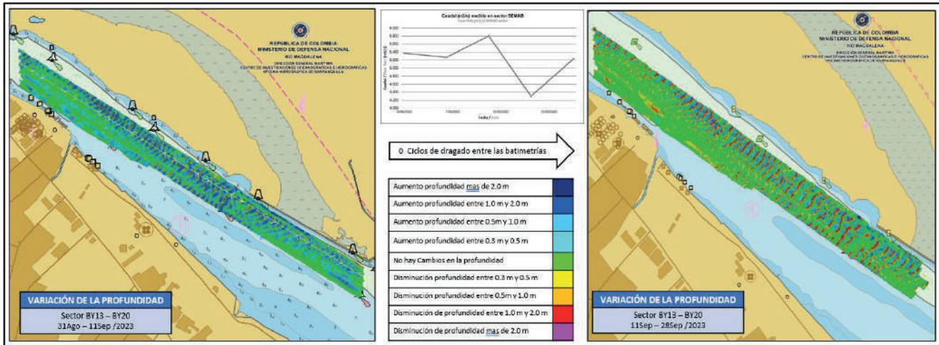
Figura 28. Diferencia de superficie entre el 11 y 28 de septiembre del 2023.
