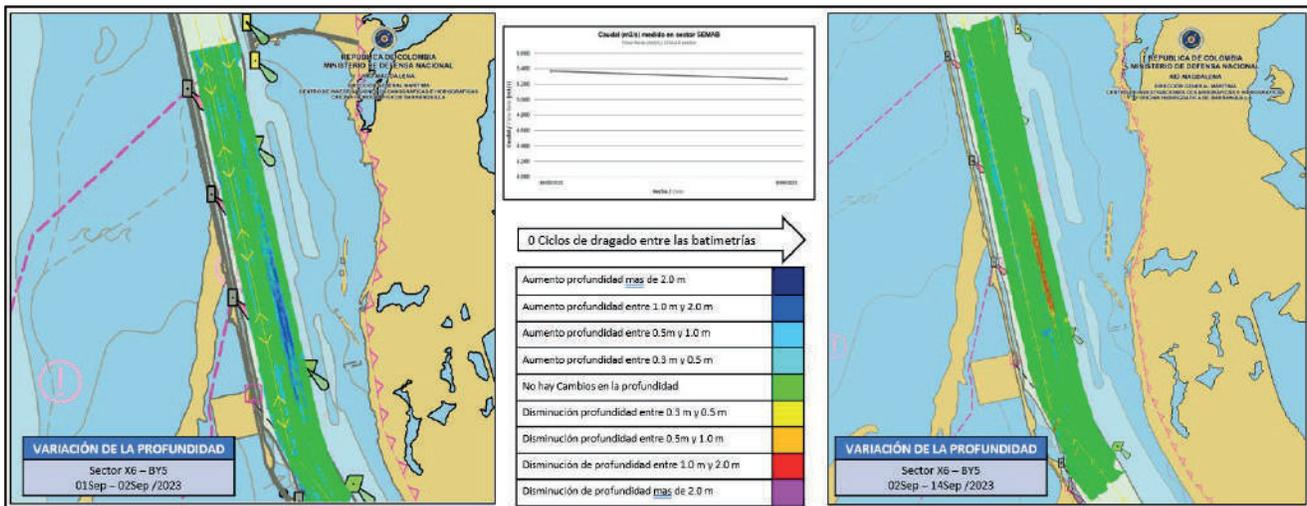
Figura 20. Diferencia de superficie entre el 02 y 14 de septiembre del 2023.
