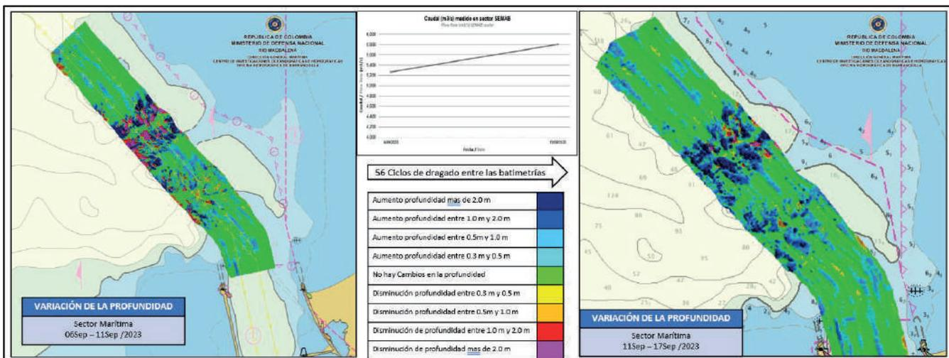
Figura 3. Diferencia de superficie entre el 11 y 17 de septiembre del 2023.
