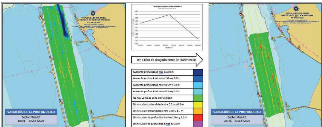
Figura 15. Diferencia de superficie entre el 20 y 23 de septiembre del 2023.
