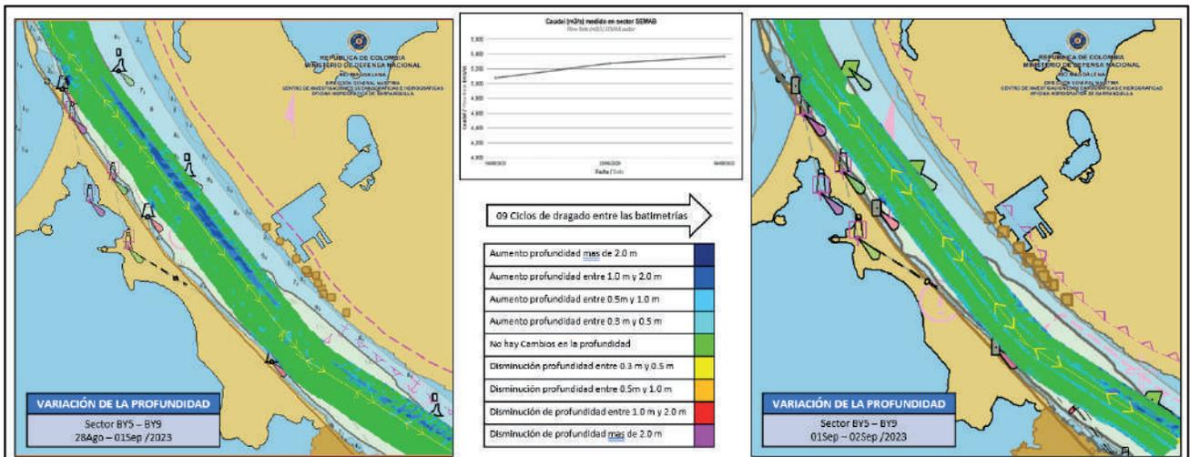
Figura 22. Diferencia de superficie entre el 01 y 02 de septiembre del 2023.
