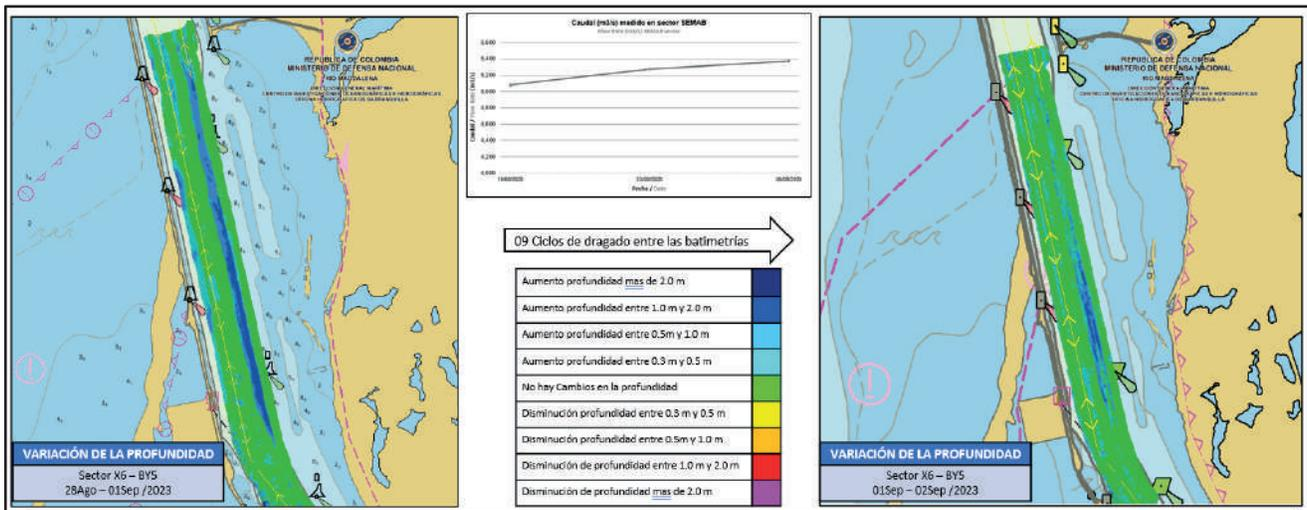
Figura 19. Diferencia de superficie entre el 01 y 02 de septiembre del 2023.
