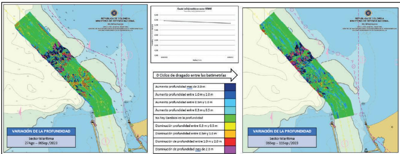
Figura 2. Diferencia de superficie entre el 06 y 11 de septiembre del 2023.
